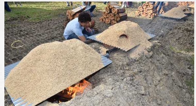
▲粃殻を敷き詰めて野焼き窯をこしらえる（写真は妻木陶磁器工業協同組合主催時のもの）
